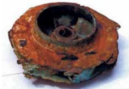
Foto 1 Efecte ale cavitației asupra rotoarelor pompelor
