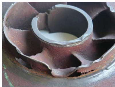
Foto. 1 Efecte ale cavitației asupra rotoarelor pompelor
