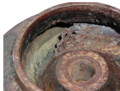
Foto. 1 Efecte ale cavitației asupra rotoarelor pompelor
